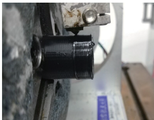
图9 在心轴上加工叶盘 Fig.9 Processing leaf disc on mandrel
